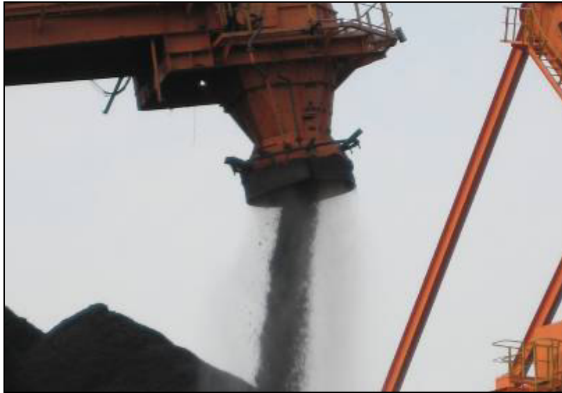
局部喷雾除尘在堆场工作现场
